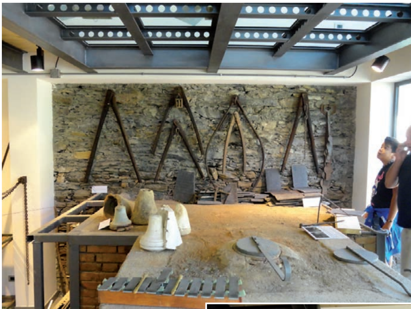
Sopra: area della fornace. Sul muro sono appesi i compassi per il tracciamento della forma della campana e, sul forno, sono appoggiate vicino al muro le tavolette in ardesia con le intonazioni dei diversi concerti. Sotto: la scala che conduce al piano superiore.
