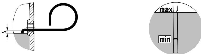
Figura 18: controllo del livello dell'olio con l'asticella di misura
