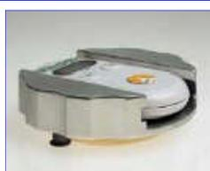
Applicatore per piastre da contatto costituito da un supporto metallico sterilizzabile in stufa o in autoclave e da un temporizzatore digitale estraibile. Consente di applicare sempre la stessa pressione per lo stesso tempo sulla piastra a contatto; in questo modo il campionamento microbiologico delle superfici è sempre riproducibile e confrontabile indipendentemente dall'operatore. Specifiche tecniche: a richiesta.
