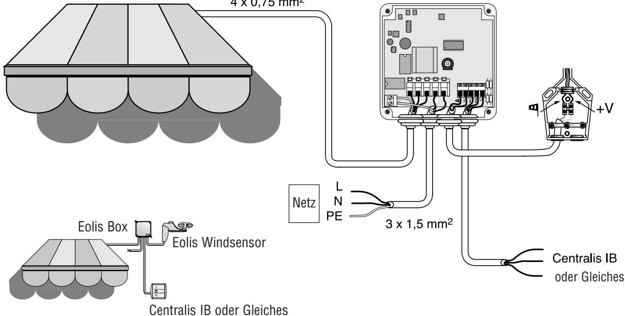
**ACHTUNG:** Bei Wind muss die Store einfahren. Wenn die Laufrichtung nicht stimmt, muss der braune und der schwarze Draht des Antriebes vertauscht werden.
