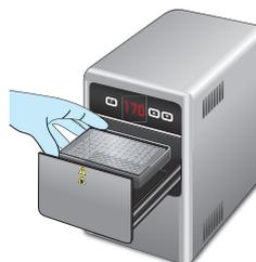
Figura 5: procedura di sigillatura con una termosigillatrice
