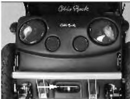
Fig. 24 Apertura del vano batterie
