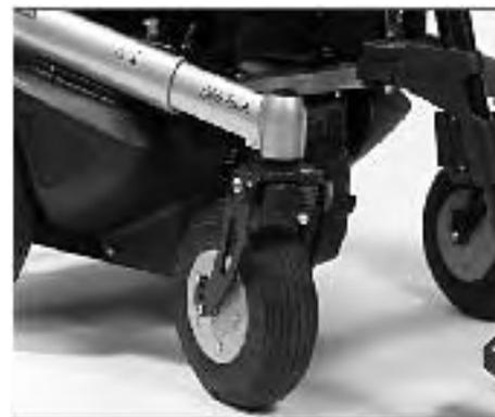
Fig. 35 Ammortizzazione delle ruotine piroettanti
