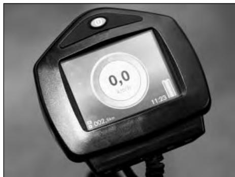
Fig. 41 Modulo LCD agli infrarossi
