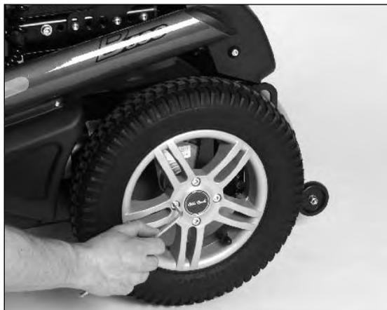
**Fig. 47** Smontaggio della ruota motrice
