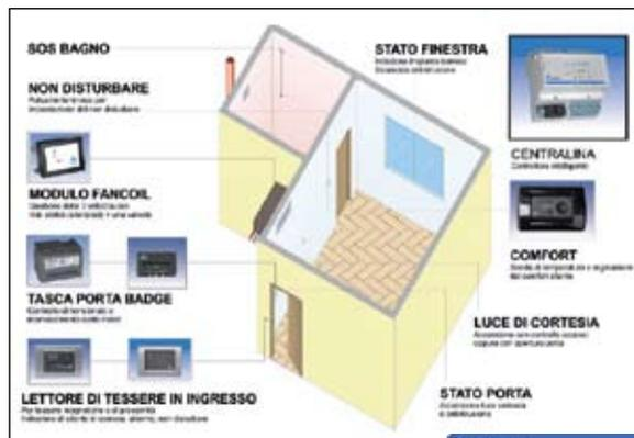
Accanto, schema della stanza tipo del Sistema Hotel di Apice. Sotto, il software Apice per la supervisione dell'albergo. In basso, la centralina MA 5600 che regola il controllo degli accessi
