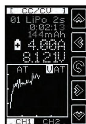
Rappresentazione grafica della curva di caricamento; toccando il simbolo VAT in alto a destra compare la curva della tensione, corrente o temperatura
