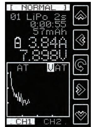
Rappresentazione grafica della curva di scaricamento; toccando il simbolo VAT in alto a destra compare la curva della tensione, corrente o temperatura
