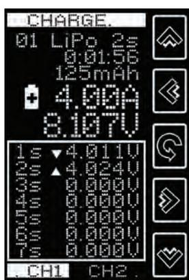
Visualizzazione della tensione delle singole celle
