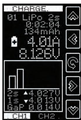
Grafico a barre con tensione delle celle e massima tensione di differenza delle celle
