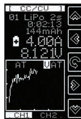
Rappresentazione grafica della curva di scaricamento; toccando il simbolo VAT in alto a destra compare la curva della tensione, corrente o temperatura
