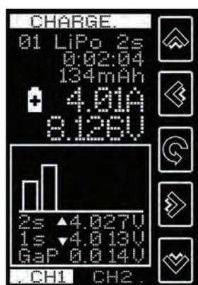
Grafico a barre con tensione delle celle e massima tensione di differenza delle celle (solo con accumulatore Lixx)
