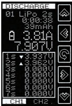
Visualizzazione della tensione delle singole celle
