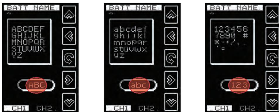
Toccare il campo di inserimento superiore in modo continuativo finché compare una tastiera di inserimento per inserire un nome dell'accumulatore.
