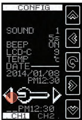
La configurazione attuale nelle impostazioni utente. Per modificare la configurazione è possibile configurare i dati con i tasti destra e sinistra. Per la configurazione dell'allarme è presente un simbolo di campana in basso a sinistra.
