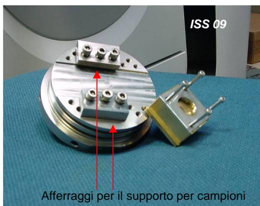
Figura 6. Base di fissaggio del campione
