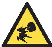
**La pressione idraulica al di là della pressione di esercizio nominale può perforare i componenti. Può causare gravi lesioni o danni alle apparecchiature.**
