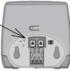
Sul lato posteriore, innestare nell'apposita presa lo spinotto del cavo dell'alimentatore in dotazione. Per installazione a parete fare due fori nel muro e fissare l'apparecchio con le viti e i tasselli in dotazione.
