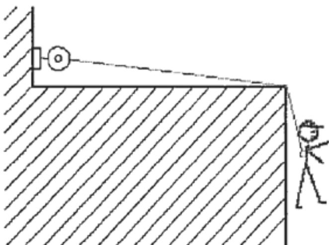
Fig. 17 - Limiti operativi del dispositivo anticaduta di tipo retrattile con punto di ancoraggio su una parete verticale
