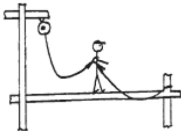
Uso dell'ancoraggio principale con l'ancoraggio di deviazione
