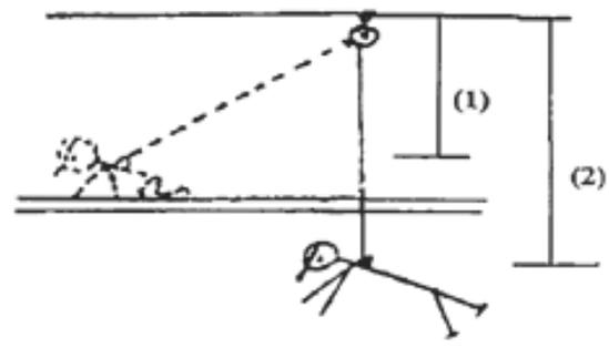
a) dispositivo di arresto su linea di ancoraggio flessibile
