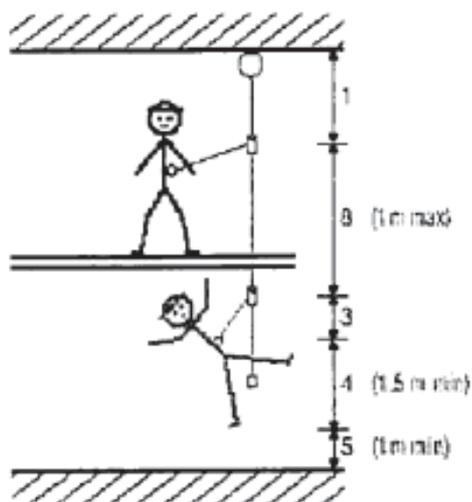
c) Dispositivo anticaduta su linea di ancoraggio flessibile
