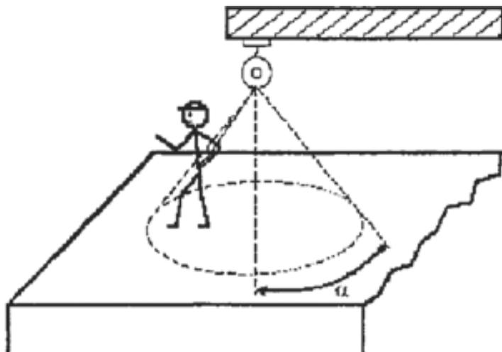
Fig. 16 - Limiti operativi del dispositivo anticaduta di tipo retrattile con punto di ancoraggio sopra l'utilizzatore
