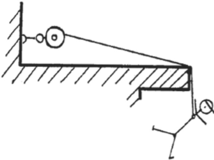
Fig. 20 – Ancoraggio disassato rispetto al punto di caduta
