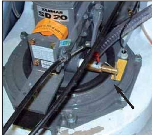
PRESA D'ACQUA DEL MOTORE
