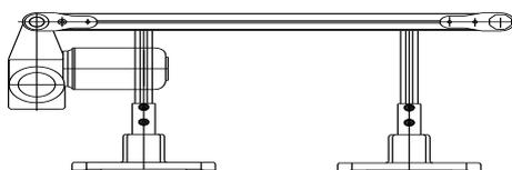
Fig. 1: Costruzione dei nastri trasportatori
