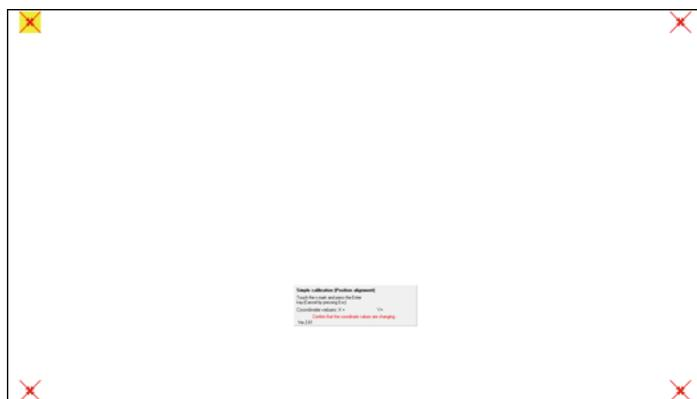
Toccare ciascuna area evidenziata, in sequenza, per configurare il sensore di contatto. L'area evidenziata da toccare si sposta da in alto a destra a in basso a destra, a in basso a sinistra e infine in alto a sinistra.
