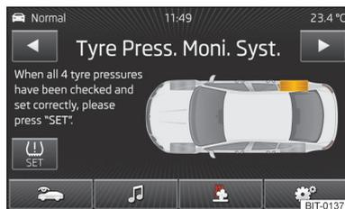
Fig. 46 Sistema di controllo della pressione pneumatici - Esempio dimostrativo: controllare lo pneumatico posteriore destro e la sua pressione
