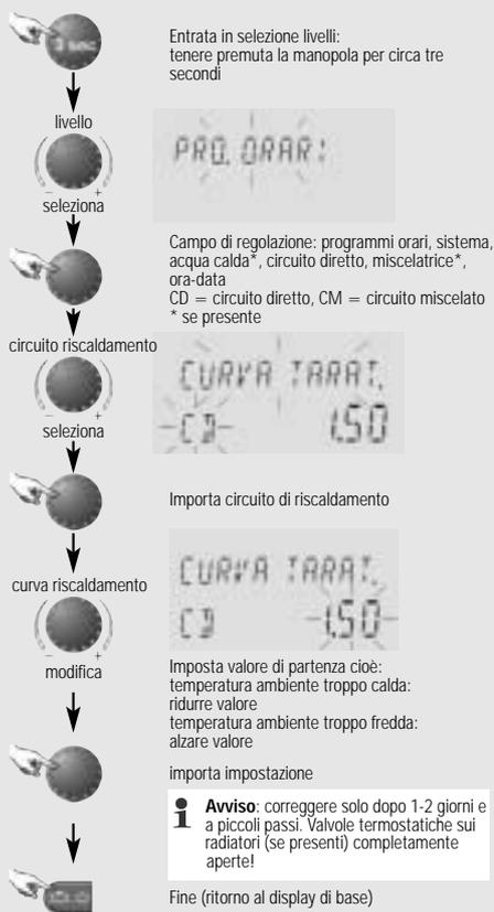
Fig. 5.2: impostazione curve di riscaldamento
