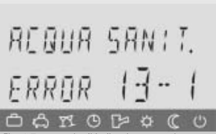
Fig. 1.7: esempio di indicazione guasti
