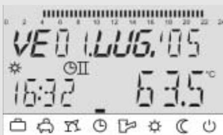
Fig. 1.4b: display base sul termostato ambiente
