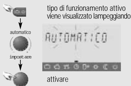
Fig. 1.12: impostare funzionamento automatico
