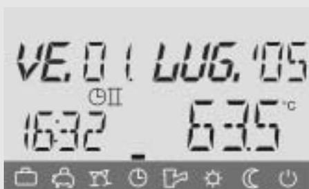
Fig. 1.4a: display base sulla centralina principale
