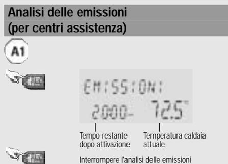
Fig. 10.1: funzione spazzacamino in caldaia a gasolio
