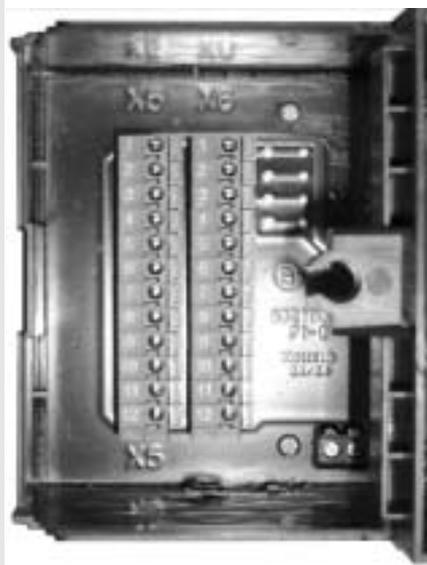
Fig. 6.9: cassetta sinistra-collegamenti sonde e BUS dati
