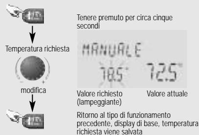
Fig. 10.2: attivazione del funzionamento manuale (anche funzionamento in emergenza)
