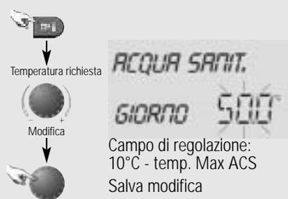
Fig. 1.10: temperatura richiesta per l'acqua calda sanitaria di giorno
