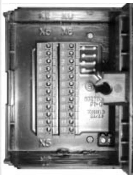
Fig. 6.9: cassetta sinistra-collegamenti sonde e BUS dati
