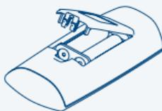
Skipper LCD funziona con due batterie alcaline da 1,5 V formato LR03 (AAA). Per la sostituzione usare solo batterie analoghe a quelle indicate. Lo smaltimento della batteria scarica deve essere effettuato facendo uso degli appositi contenitori e comunque in conformità alle leggi nazionali.
