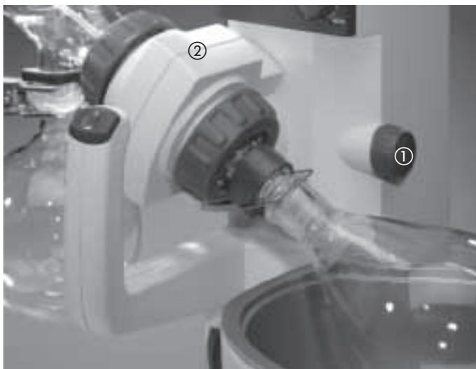
Figura 13: Grafico del motore visto dalla parte anteriore, con vite di bloccaggio
