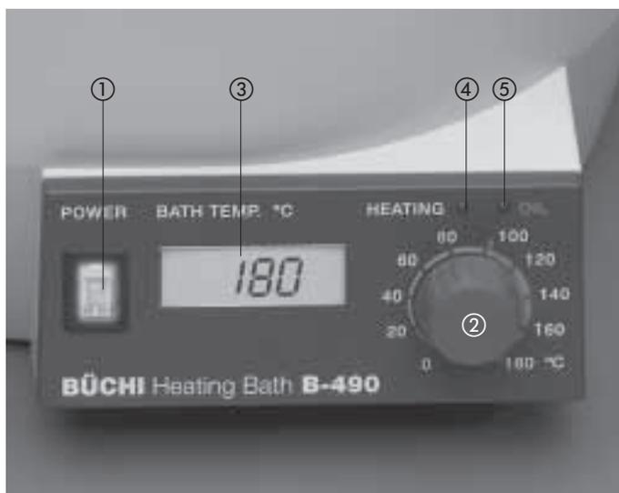
Figura 25: Pannello frontale del bagno riscaldante B-490
