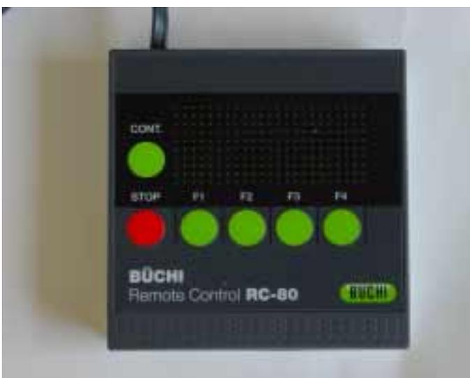
Figura 5: Foto con telecomando per V-800/805
