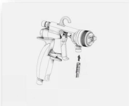
1. Utilizzare un filtro per il fluido per rimuovere le particelle di sporco ed i sedimenti, per evitare ostruzioni nell'ugello che causerebbero difetti di finitura.
