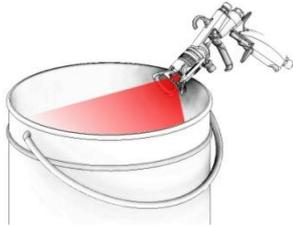
6. Aprire tutte le valvole di scarico del fluido nel sistema avendo a disposizione un contenitore per la raccolta del drenaggio. Lasciare aperta la valvola di scarico fino alla successiva operazione di spruzzatura.
