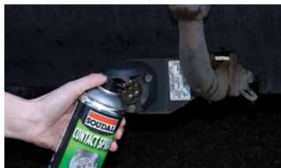
Pulizia e manutenzione contatti elettrici
