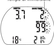
Tutto il tempo trascorso ad una profondità superiore ad 80 cm viene mostrato, in minuti, come tempo di immersione. Il tempo passato, dopo l'accensione dello strumento, al di sopra di questa profondità viene conteggiato come tempo di immersione soltanto se il subacqueo scende sotto 80 cm entro 5 minuti.
