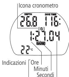
In modalità gauge, una volta immerso in acqua, Aladin® *TEC* inizierà a monitorare la durata dell'immersione, inoltre attiverà il cronometro. Il cronometro funzionerà al massimo per un'ora ed al massimo per 24h in immersione.
