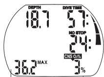
La profondità massima viene indicata solo se supera il valore della profondità attuale di più di un metro (funzione indicatore di massima). Quando la profondità massima non viene mostrata Aladin® visualizzerà la temperatura nella stessa area del display.
