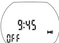
La sveglia suona solo in superficie, per funzionare è necessario che il parametro "Suono" sia impostato su "on" nel menu "set 2".
