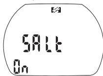
1. Confermare di voler cambiare l'impostazione del tipo di acqua premendo . "On" o "off" inizia a lampeggiare. "Salt on" significa acqua salata, "Salt off" significa acqua dolce.
