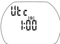
L'impostazione della differenza UTC permette di cambiare rapidamente ora quando ci si sposta in una zona appartenente ad un diverso fuso orario.
