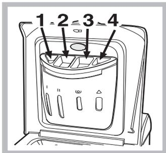
Alzare il coperchio al di sotto del quale è collocato il cassetto dei detersivi e inserire il detersivo o l'additivo come segue.
