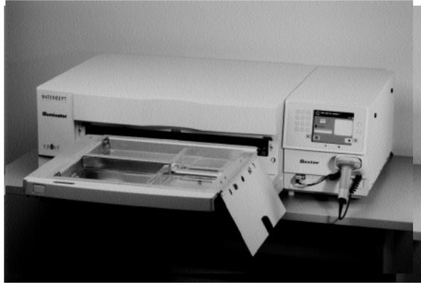
Nella camera anteriore (camera numero 1) vengono collocati un emocomponente e il set di trattamento corrispondente. L'emocomponente, nell'apposito contenitore per l'illuminazione, viene posto sul lato sinistro della camera e il resto del set sul lato destro.
