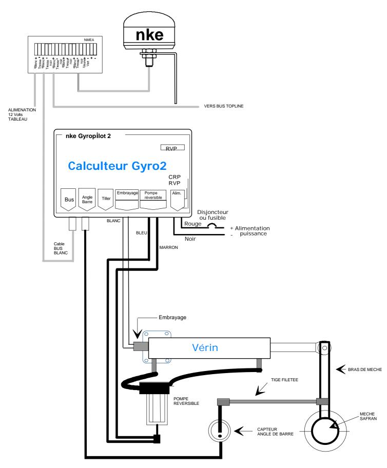
Nel caso di un collegamento del calcolatore Giropilot 2 RVP ad **una pompa reversibile sola**, i cavi bianchi di frizione non saranno collegati e isolati elettricamente.
