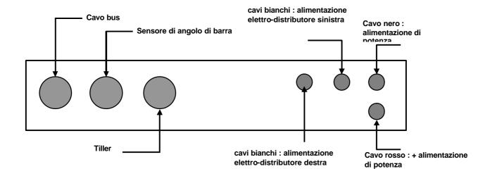
Il calcolatore GIROPILOT 2 **CRP** è previsto per controllare gli elettro-distributori di un gruppo elettro-pompa idraulica con un'erogazione fisso, generalmente montato sulle grosse barche da diporto, da pesca e da schiavitù.
