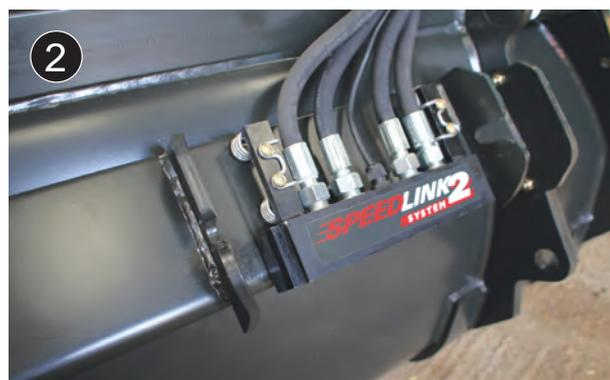
Un indicatore rosso/verde posto sul retro del ricevitore SPEED-LINK 2 informa il conducente, dal posto di guida, della condizione di blocco dell'attrezzo.
