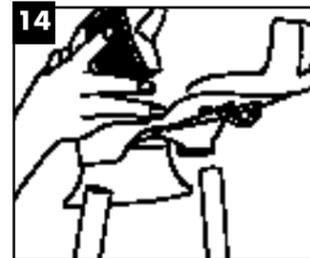
Aggiungere innanzitutto del lubrificante alle sommità delle gambe. Con le mani, abbassare la testa di alimentazione Liberty sul gruppo delle gambe allineando i fori della testa di alimentazione con le sommità delle gambe (tubo del gas e regolatore rivolti verso le ruote posteriori). Serrare completamente il gruppo delle gambe.
