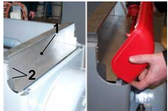
H Kablo koruma kutusunu " 1 " vidalarla " 2 " yan panellere sabitleyip kumanda panelini yerleştirin.
