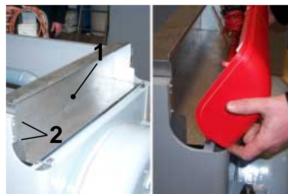
H Fastgør kabelbeskyttelsesdåsen „1” ved hjælp af skruerne „2” på sidepanelerne og anbring kontrolpanelet (inkl. kabelføringen).
