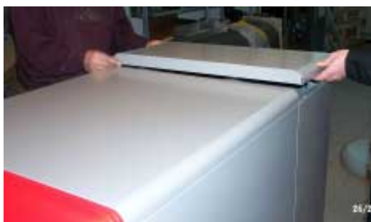
M Monte as tampas seguindo a sequência indicada no parágrafo "B".
