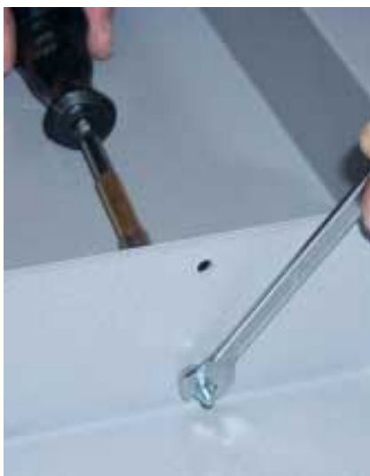
C Das rechte und das linke Seitenteil miteinander verbinden und befestigen, dabei die Übersichtstabelle unter Punkt "B" befolgen.
