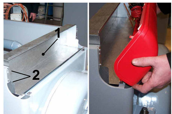
H Στερεώστε το κιβώτιο προστασίας καλωδίων “1” με τις βίδες “2” στα πλευρά και τοποθετήστε τον καλωδιωμένο πίνακα.
