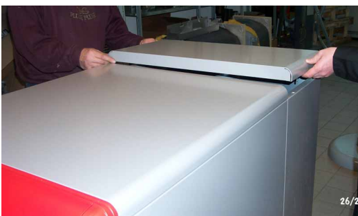
M Τοποθετήστε τα καπάκια ακολουθώντας τη διαδικασία στο σημείο “B”.
