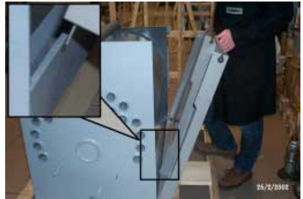
F Die Seitenteile am Kesselkörper anbringen.
