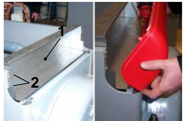
H Das Kabel-Schutzgehäuse „1“ mit den Schrauben „2“ an den Seitenteilen befestigen und die verkabelte Bedienblende anbringen.
