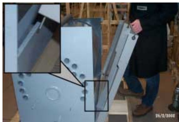
F Posizionare i fianchi sul corpo caldaia.
