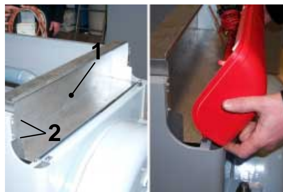
H Fissare la scatola protezione cablaggio "1" tramite le viti "2" sulle fiancate laterali e posizionare il cruscotto cablato.
