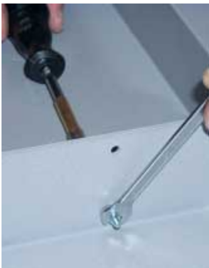
C Saml og fastgør højre og venstre sideplade i henhold til tabellen under punkt "B".
