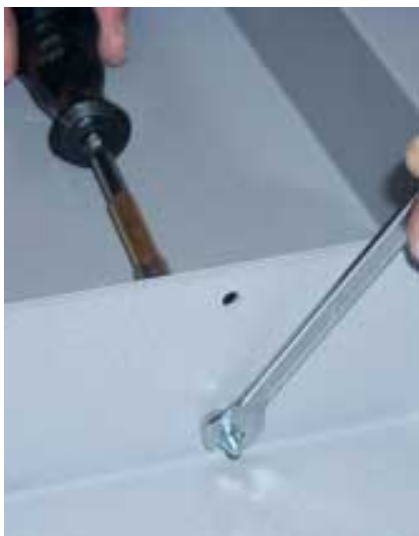
C Accoppiare e fissare le fiancate destra e sinistra, seguendo la tabella riassuntiva al punto "B".
