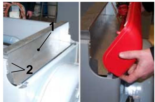
H Bevestig de beschermingskast van de bekabeling "1", met behulp van de schroeven "2" aan de zijflanken en monteer het bekabeld instrumentenbord.
