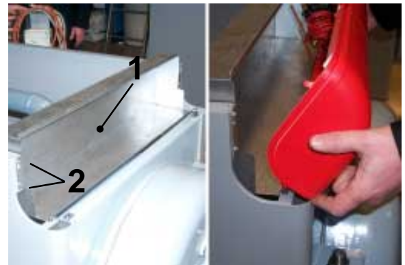
H fixer la boîte de protection du câblage «1» à l'aide des vis «2» sur les côtés et placer le tableau de bord câblé.
