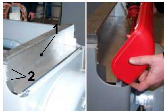
H Fijar la caja de protección de cableado "1" mediante los tornillos "2" en los flancos laterales y posicionar el cuadro de mandos cableado.
