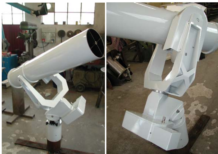
Fig. 80 – Particolari del tubo, forcella e testa equatoriale assemblati del telescopio TNC
