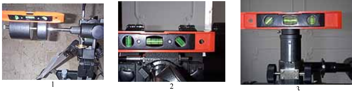
Fig. 63 – Fasi di verifica dell'ortogonalità del foceggiatore rispetto al tubo ottico
