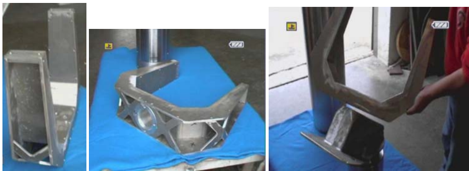
Fig. 78 – Particolari della forcella del telescopio TNC
