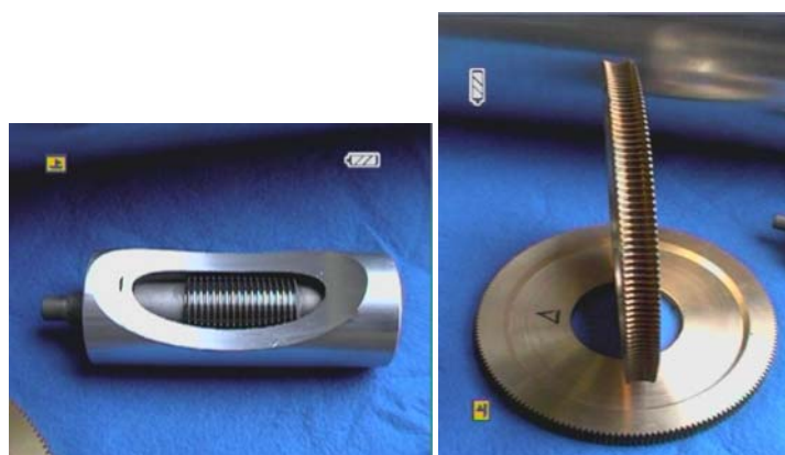
Fig. 82 – Particolari della vite senza fine e ruote dentate del telescopio TNC
