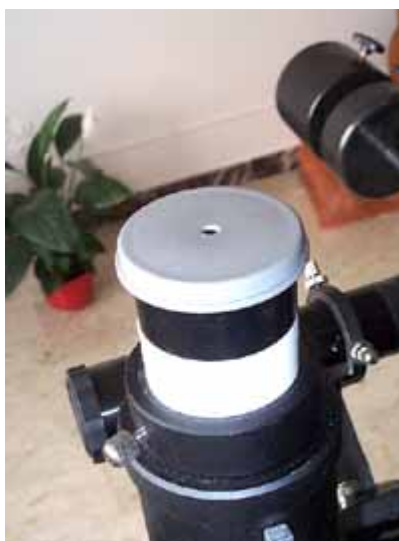
Fig. 69 – Strumento per la correzione dell'inclinazione dello specchio secondario
