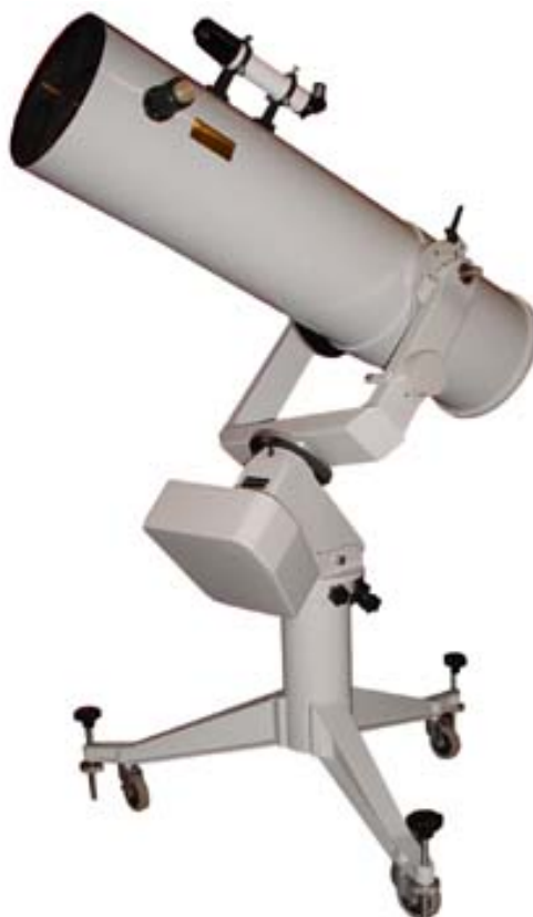
Fig. 76 – Il telescopio TNC dell’OAC, newtoniano equatoriale a forcella
