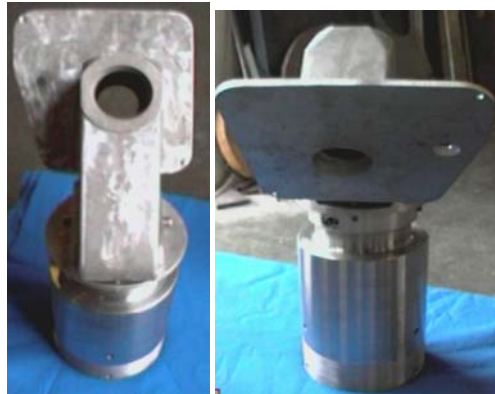
Fig. 77 – Particolari della base e testa equatoriale del telescopio TNC
