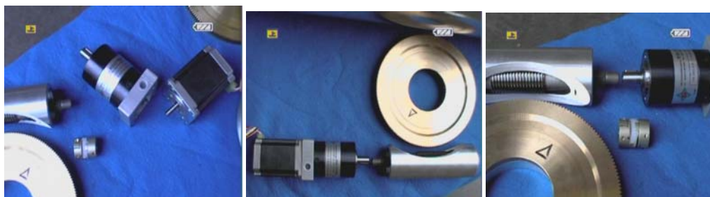
Fig. 83 – Particolari del motore, giunto e riduttori in AR del telescopio TNC
