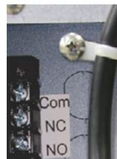
*Installazione dello scarico anti-tensione per il cavo di alimentazione sui modelli sottobanco*
