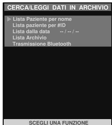
Da questa sezione è possibile anche effettuare la trasmissione dell'intero archivio tramite connessione Bluetooth ad un telefono cellulare (vedere a riguardo il paragrafo 3.1).
