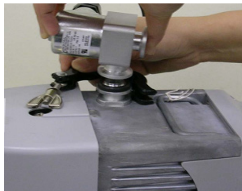
Figura 9 Valvola di ingresso montata sulla pompa IDP-3
