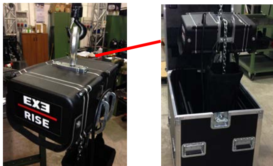
Figura 19: Sollevare il paranco ed agganciarlo al punto di ancoraggio della struttura
