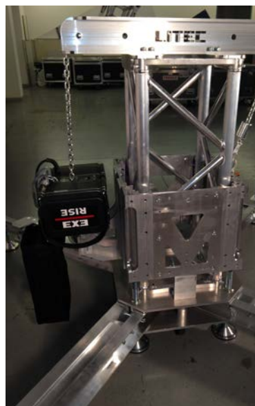
Figura 18: Esempi di montaggio del paranco in modalità autosollevante.
