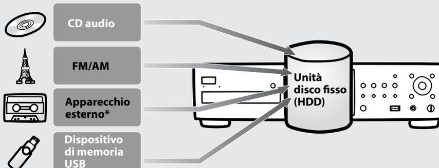
\* È possibile collegare un apparecchio analogico (quale una piastra a cassette) alle prese ANALOG IN della presente unità per effettuare registrazioni analogiche. È possibile collegare un apparecchio digitale (quale un sintonizzatore digitale) alla presa DIGITAL COAXIAL IN o al connettore DIGITAL OPTICAL IN dell'unità per effettuare registrazioni digitali.
