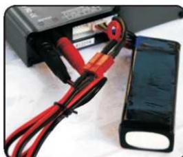
Per caricare usando il bilanciatore, l'accumulatore deve essere collegato all'uscita di carica e alla porta del bilanciatore (vedere figura).
