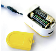
Figura 3 Installazione delle batterie
