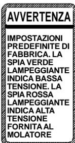
Il molatore è dotato di un relè di alta/bassa tensione che presenta l'impostazione predefinita di fabbrica a 100-140 VCA. Se la linea di alimentazione non fornisce alimentazione a 100-140 VCA sotto carico, il relè si apre e blocca l'avviamento. Se si verifica ciò, la linea di alimentazione è errata e deve essere corretta prima di procedere ulteriormente con il molatore.
