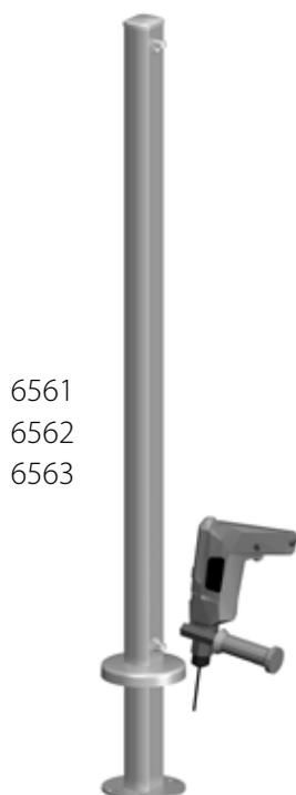
**1.** Sistemare il montante a pavimento nella posizione desiderata, sollevare il coperchio in plastica del montante e prendere le misure per il foro nel pavimento. Spostare il montante e praticare il foro.
