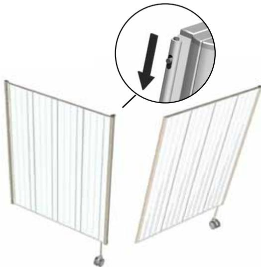
6. Fissare il separé esterno a quello interno seguendo la procedura di fissaggio del separé interno all'attacco a parete.
