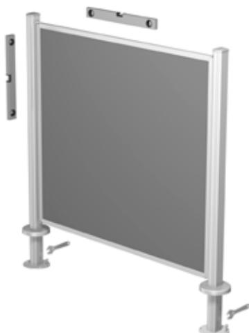
**2.** Riportare il separé in posizione e verificarne **l'orizzontalità** e **la verticalità**. Avvitare i montanti a pavimento.
