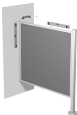
**2-3.** Sistemare il separé contro la parete a cui dovrà essere montato e verificarne **l'orizzontalità e la verticalità**.
