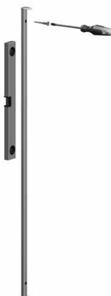
**2.** Fissare alla parete l'estremità inferiore dell'attacco. L'estremità superiore dell'attacco a parete è contrassegnata da una freccia e dalla dicitura UP.
