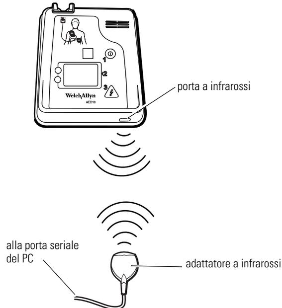
**Nota** Tenere la porta a infrarossi del defibrillatore AED 10 e il cavo adattatore a infrarossi a una distanza di circa 15 - 25 centimetri.
