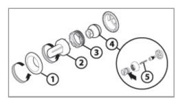
Servendosi dell'apposita chiave (2-Jet idromassaggio) smontare la griglia di copertura.
