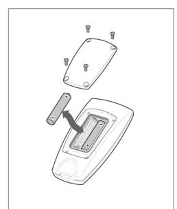
Per sostituire le batterie dal Telecomando togliere il coperchio di protezione svitando le quattro viti di serraggio.
