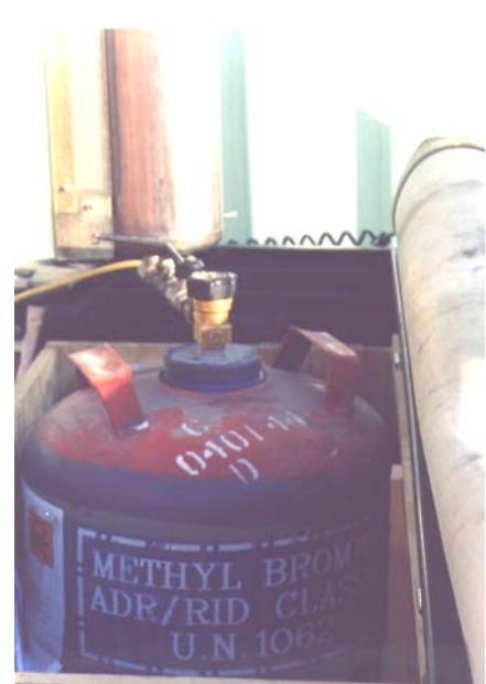
Per il raccordo è utilizzata un'apposita tubazione collegata a tenuta con la valvola di erogazione delle bombole .Il gas arriva al container con una cannula , inserita nella guarnizione dei battenti delle porte.
