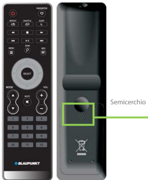
1. Per aprire il vano batteria, far scorrere il coperchio del vano batterie sul retro del telecomando verso il punto del semicerchio (vedi figura sopra).
