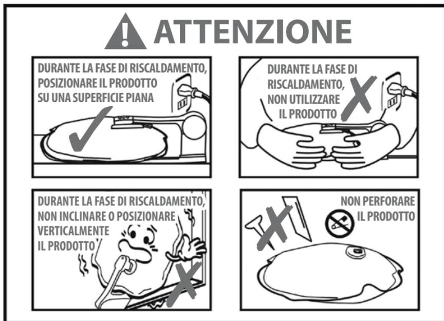
Non utilizzare il prodotto quando è collegato alla rete (fase di riscaldamento). Una volta che il prodotto si è riscaldato, scollegarlo dalla rete ed utilizzarlo.
