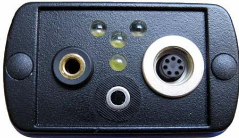
L'uscita degli auricolari si trova a sinistra (ingresso di 3,5mm). L'ingresso dell'accelerometro si trova a destra. Il sensore di temperatura senza contatto è nella parte inferiore. Quattro LED strobo si trovano nella parte superiore.
