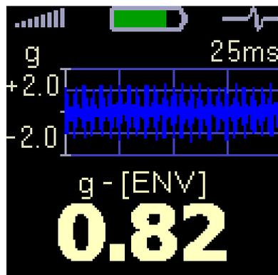
Sul display appare il segnale del tempo delle vibrazioni del cuscinetto.  $g_{ENV}$  Il valore è sotto il segnale del tempo (segnale modulato – vedere il capitolo dei metodi per la diagnosi dello stato dei cuscinetti) Precauzione – il segnale del tempo appare come una registrazione diretta. Osservare questi tre display di base per utilizzare meglio questa funzione.
