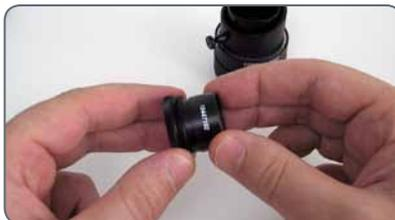
3. Serrare l'inserto con il reticolo e inserire l'oculare nuovamente nel tubo.
