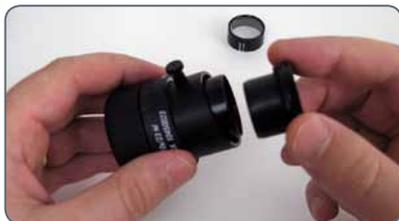
2. Fare scattare saldamente il reticolo nell'oculare esercitando una leggera pressione. Accertarsi che il reticolo sia saldamente in sede.
