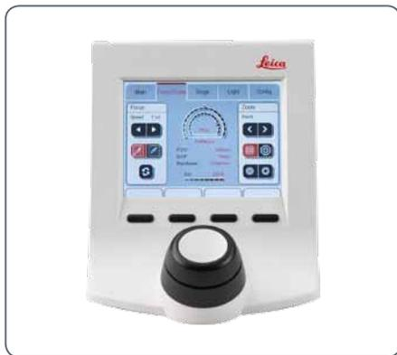
**i** Il Leica SmartTouch permette di controllare, memorizzare e richiamare quando necessario tutte le funzioni automatiche. Da ciò deriva la massima sicurezza nell'esperimento poiché ogni situazione può essere ripetuta in modo semplice e veloce.
