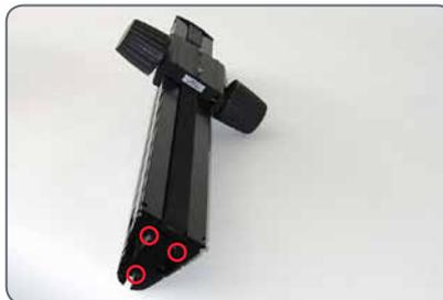
2. Tenere la base a luce incidente sulla colonna di messa a fuoco e fissare questa con le tre viti accluse alla base.
