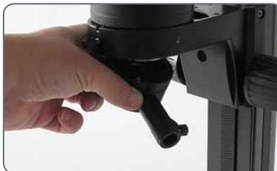
2. Orientare l'illuminazione coassiale in modo che la presa per il conduttore a fibre ottiche punti nella direzione più comoda per lavorare.
