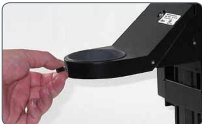
3. Serrare la vite di arresto del supporto del microscopio.
