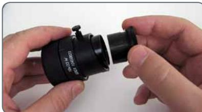
4. Ora è possibile allineare il reticolo ruotando l'oculare nel tubo e poi fissarlo con la vite di serraggio.
