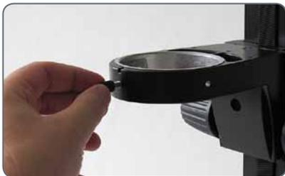
2. Collocare il tubo nel supporto del microscopio.
