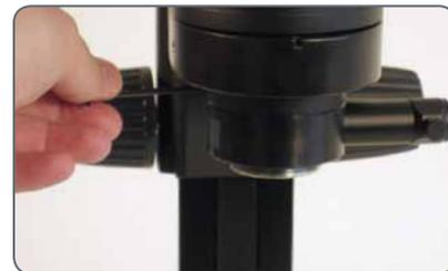
4. Collegare il conduttore a fibre ottiche della sorgente a luce fredda Leica all'illuminazione coassiale.
