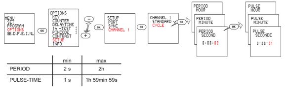
Il canale 1, contrariamente alla funzione STANDARD, viene cadenzato ciclicamente. Parametri impostabili sono PERIODO (durata del periodo) e IMPULSO (durata di inserimento per periodo).
