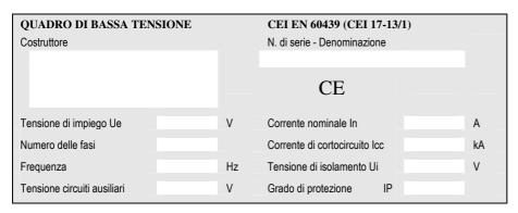
La targa deve essere di tipo metallico, serigrafata, o comunque realizzata in modo da garantire l'inalterabilità nel tempo, fissata sul fronte del quadro in modo da essere ben visibile, con incisi i dati caratteristici.
