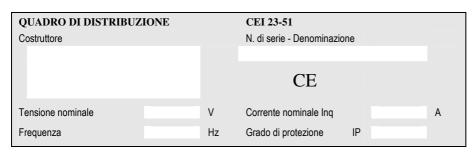
La targa deve essere di tipo metallico, serigrafata, o comunque realizzata in modo da garantire l'inalterabilità nel tempo, fissata sul fronte del quadro in modo da essere ben visibile, con incisi i dati caratteristici.
