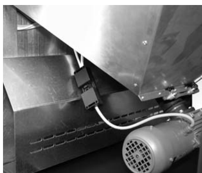
Fig. 13 - Togliere la spina del motore della coclea.
