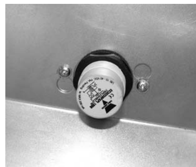
Fig. 15 - Allentare l'interruttore di livello.
