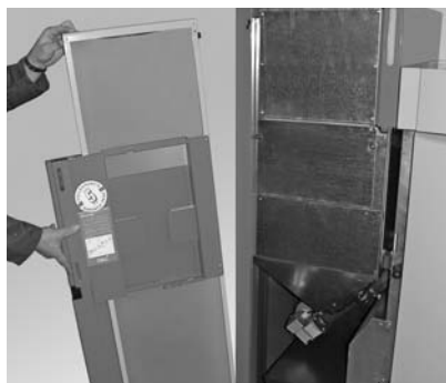
Fig. 7 - Sganciare la porta di rivestimento.
