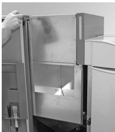
Fig. 41 - Svitare il coperchio per ispezione sopra.
