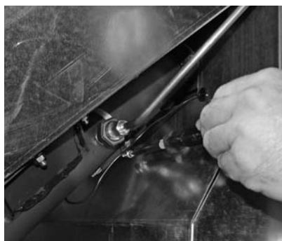
Fig. 11 - Allentare la sicura della sonda.
