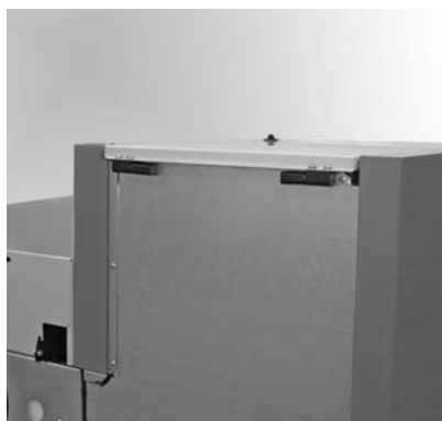
Fig. 35 - Montare le due bande (stiva).
