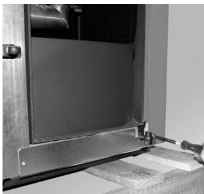
Fig. 30 - Svitare l'angolare di collegamento.
