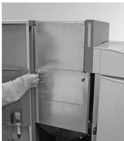
Fig. 40 - Svitare il coperchio per ispezione sotto.
