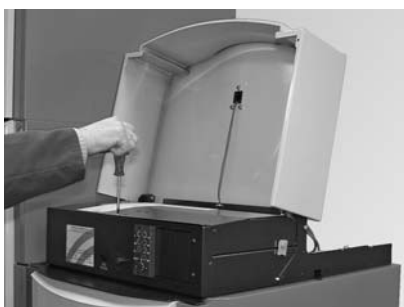
Fig. 52 - Allentare la vite anteriore.
