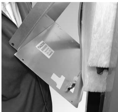
Fig. 25 - Staccare l'interruttore di sicurezza della porta.
