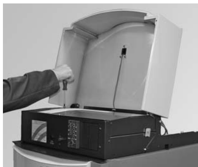
Fig. 19 - Allentare le due viti, togliere il coperchio del quadro.
