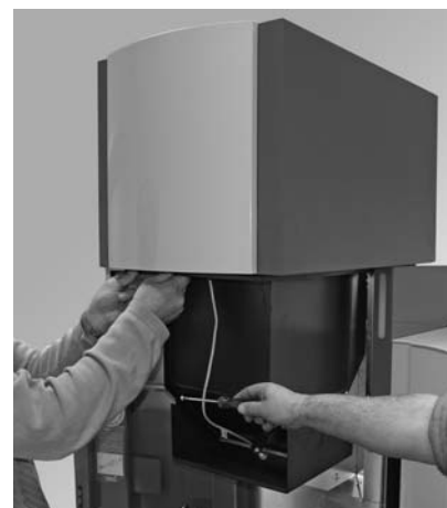
Fig. 42 - Alzare l'unità di convogliamento sulla stiva, togliere la protezione per trasporto.
