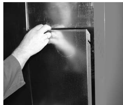
Fig. 9 - Sfilare la parete posteriore.
