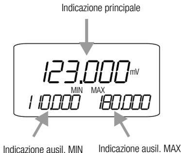
Mentre l'indicazione principale appare subito dopo l'accensione del multimetro, le due indicazioni ausiliarie devono essere attivate manualmente, premendo il tasto DATA/CLEAR. In questo modo si impedisce che lo stato (non definito) all'inizio della misurazione, p. es. una tensione a vuoto, continui a figurare come valore massimo.
