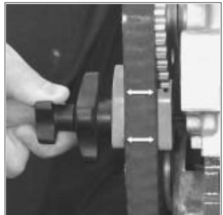
Fissare l'insieme sulla ruota dentata avvitando a fondo la grande manopola di bloccaggio.
